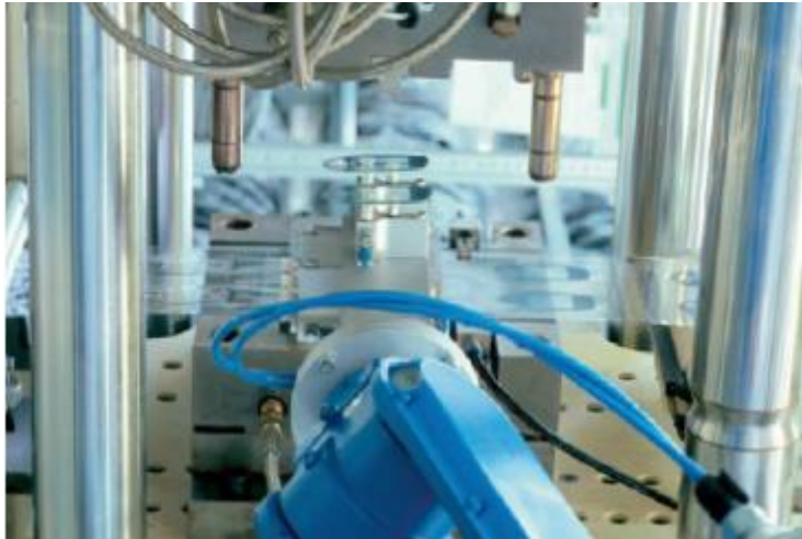
通过使用 GOM 的测量设备，生产过程中的修正循环从 7 次下降到 3 次
